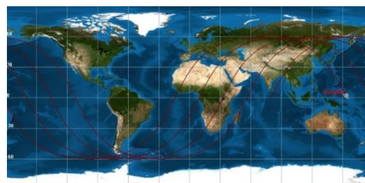
Рисунок 1. Рассчитанная орбита наноспутника
